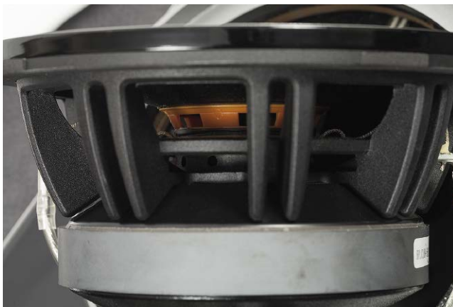
Tak duży magnes prawdopodobnie pracuje na rzecz układu "krótka cewka – długa szczelina", na co wskazuje wysoki (wyprofilowany) górny nabiegunnik. Układ taki zapewnia niskie zniekształcenia, ale ma niższą sprawność (niż klasyczny układ "długa cewka – krótka szczelina" przy określonej różnicy długości cewki i szczeliny, decydującej o amplitudzie liniowej, i określonej wielkości magnesu), dlatego do osiągnięcia dobrego poziomu wszystkich parametrów wymaga większego magnesu. Widać też cewkę o dużej średnicy, prowadzoną przez podwójne dolne zawieszenie.
